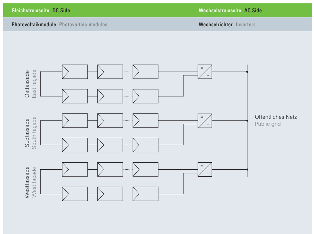
Beispiel-Verschaltung Example wiring
