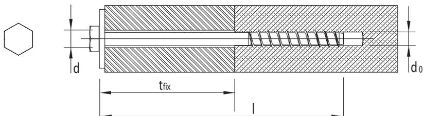
d Diameter\* · l Length · d<sub>0</sub> Hole diameter · t<sub>fix</sub> Clamp length · **All dimensions in mm**
