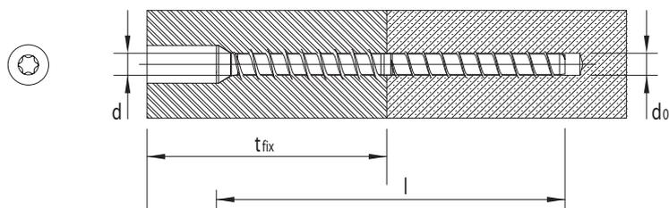
d Diameter\* · l Length · d<sub>0</sub> Hole diameter · t<sub>fix</sub> Clamp length · **All dimensions in mm**
