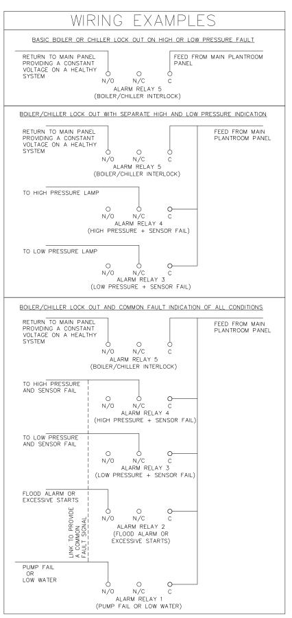
THE ABOVE RELAYS ARE SHOWN IN AN ENERGIZED STATE WHEN THE UNIT IS POWERED UP. THE RELAYS WILL DE-ENERGIZE ON A FAULT OR IF THE UNIT POWER IS TURNED OFF.
